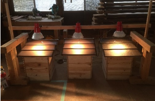
写真2: 試験体に加熱用投光器を照射した状態 (左から普通屋根、通気下地材+屋根、通気下地材+断熱塗料屋根)
